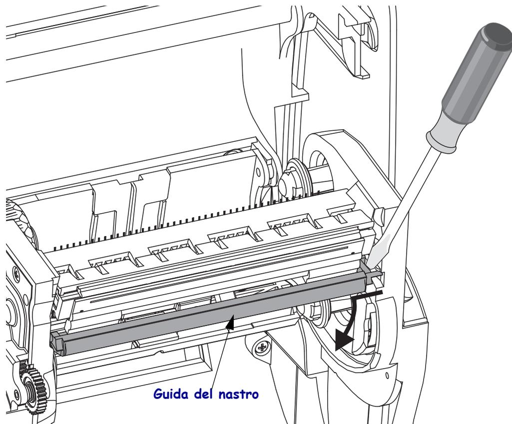
3. Utilizzare uno strumento a punta smussata per premere la linguetta di rilascio della testina di stampa su entrambi i lati della testina. Il diametro dello strumento può variare tra 2,5 e 3,8 mm (0,10 e 0,15 pollici).
