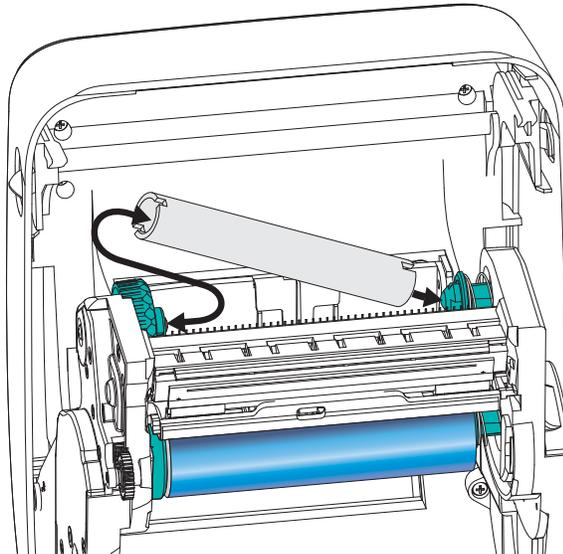
La prima bobina di avvolgimento del nastro si trova nella confezione. In seguito, utilizzare la bobina di alimentazione vuota per avvolgere il rotolo di nastro successivo.
