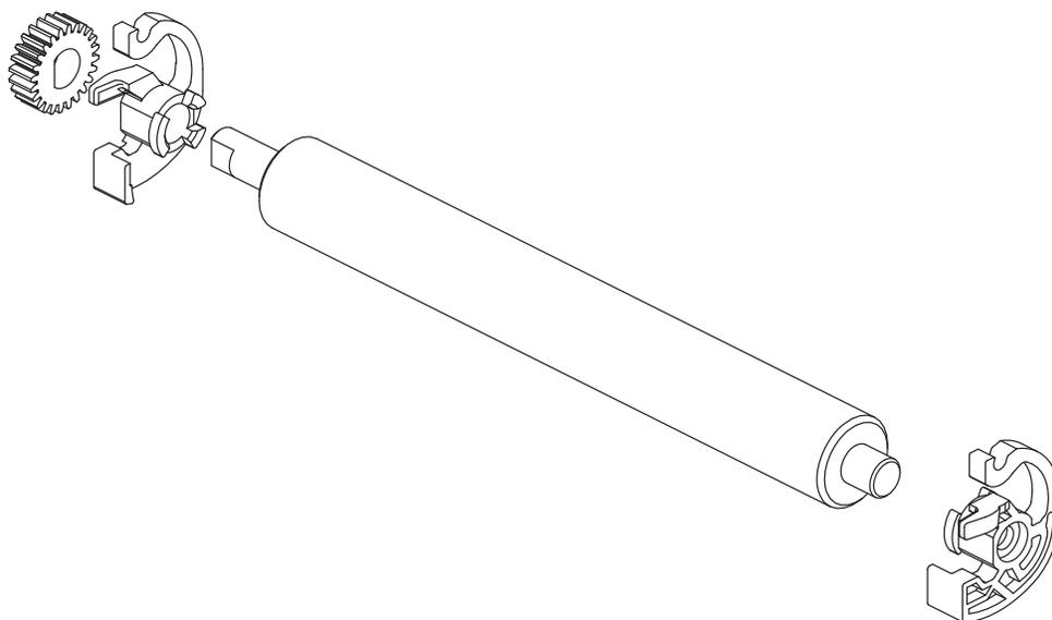
7. Allineare il rullo all'ingranaggio sulla sinistra e inserirlo nel telaio inferiore della stampante.
